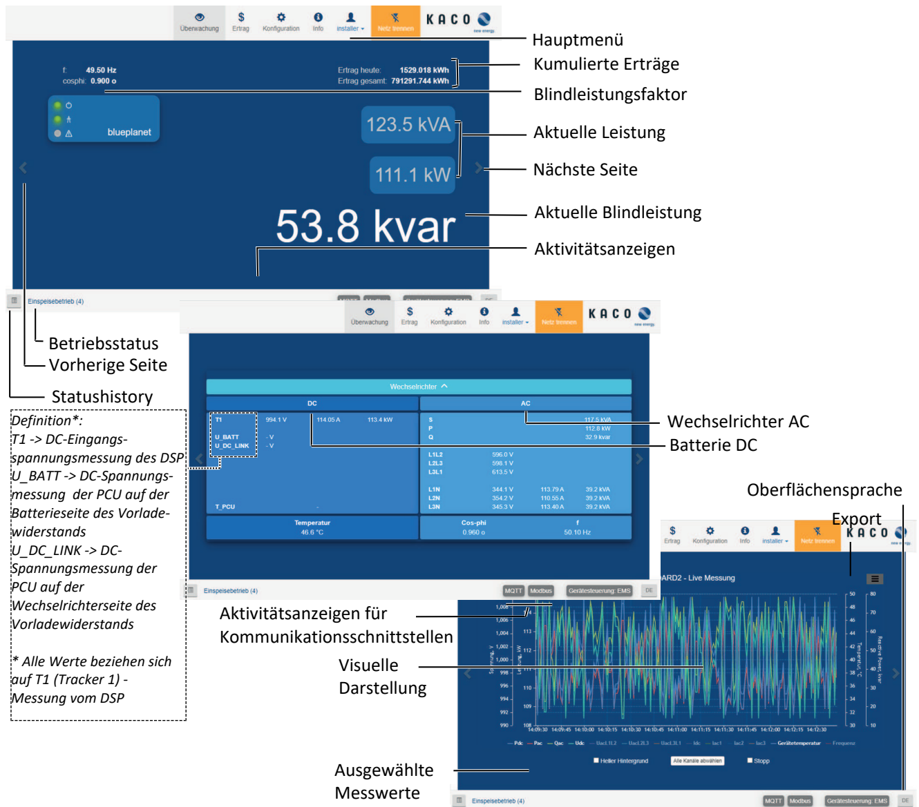
Abb. 44: Oberfläche für Monitoring
