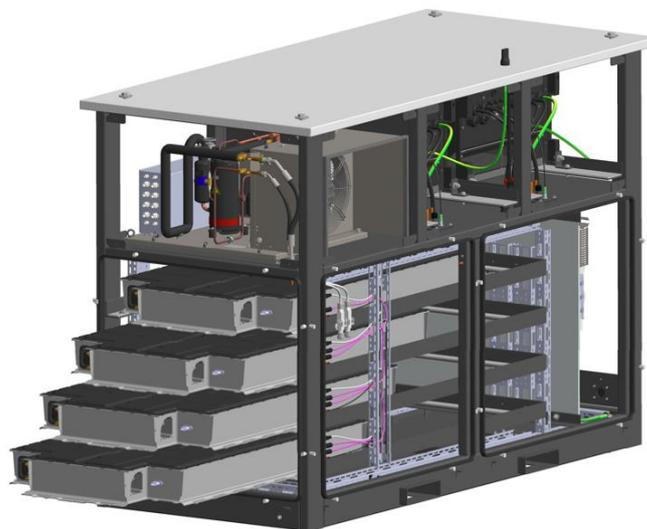
Niederschlagswasser kann durch die Lüfteröffnung an den Seiten in den Container eintreten, jedoch nicht in den Batterieraum gelangen.
