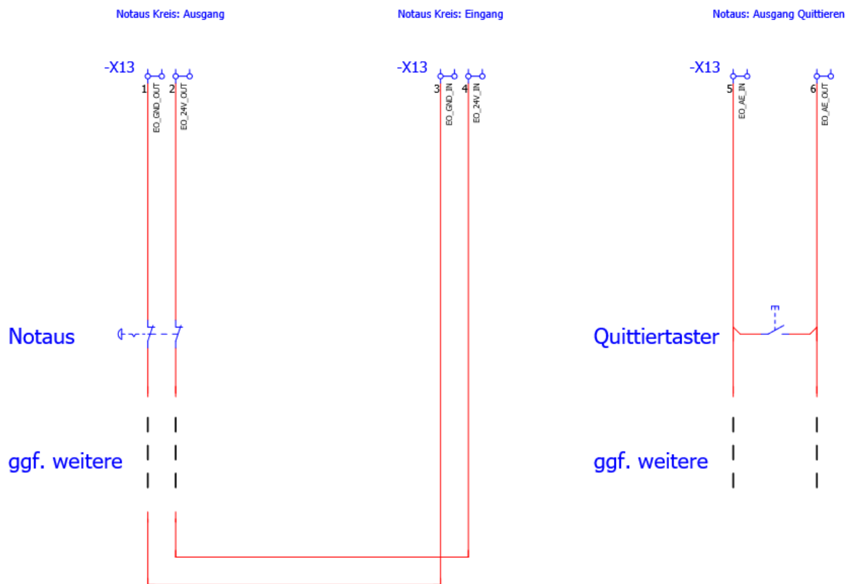
Illustration 27. Anschlussbeispiel — Externer Not-Halt und Quittiertaster — AA3, AA4
