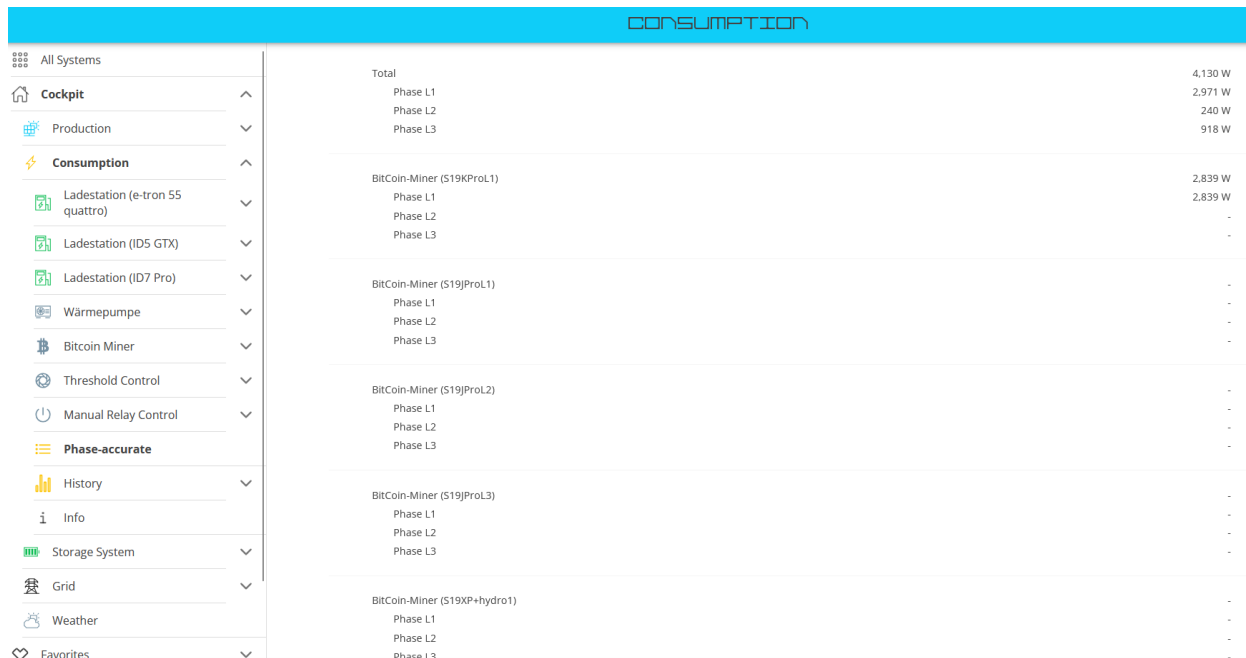
Abbildung 9. Hauptmenüpunkt — Verbrauch — Phasengenaue Ansicht
