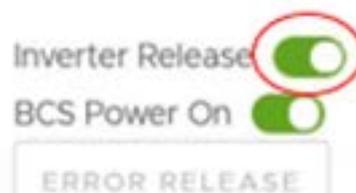
25. Zuerst den in der oberen Abbildung markierten, oberen Button "Inverter Release" für alle Speicher einzeln ausschalten. Mit dem ersten PCS beginnen und bis zum letzten PCS nach unten den Button "Inverter Release" ausschalten.
