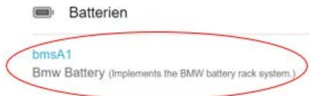
23. Bei allen bmsA1-B4 einzeln in der Zeile "Battery state" auf "Stop" ändern und anschließend den Button "AKTUALISIERE KOMPONENTE" betätigen.
