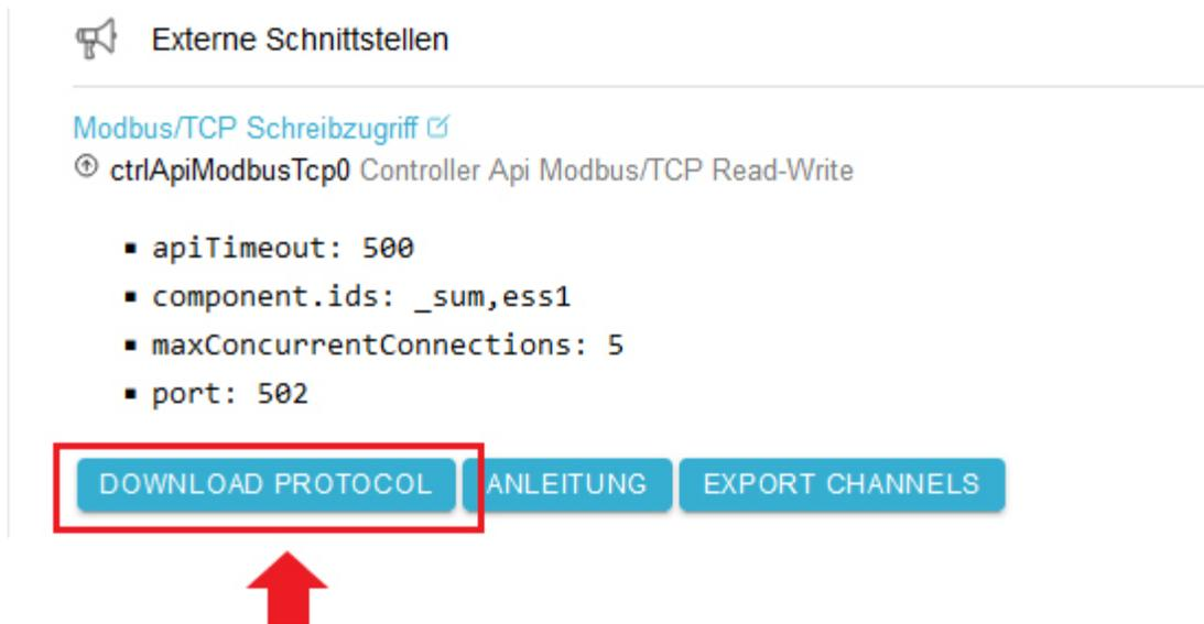
Abbildung 4. ctrlApiModbusTcp öffnen und auf "Download Protocol" klicken
