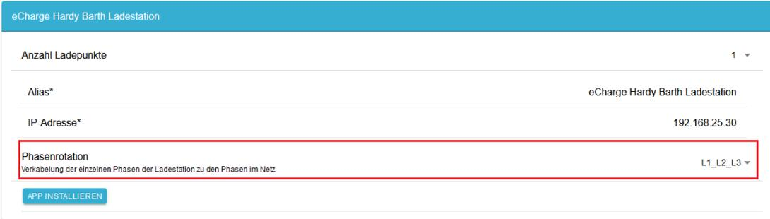
Abbildung 22. App-Installation — Phasenrotation: Schritt 1
