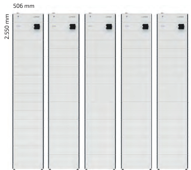
Systemvariante 5 Türme mit je 15 Modulen
