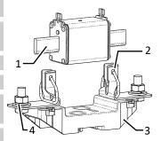
Fig. 56: Insert DC fuse
