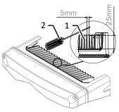
Fig. 53: Clean the cooling fins
